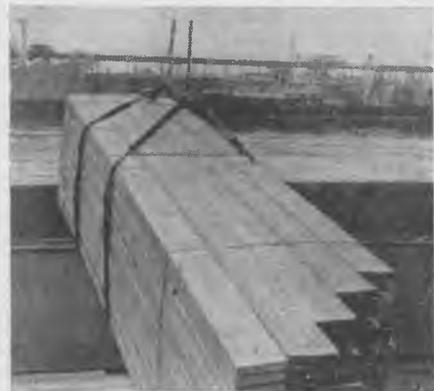
Рис. 2. Пакет пиломатериалов в момент погрузки
