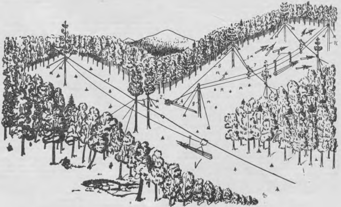
Рис. 1. Схема подвесной канатной установки для подачи леса из поперечно-ленточных лесосек к ВТУ-3
