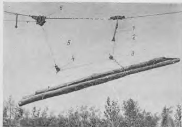
Рис. 1. Установка ВТУ-3 с дополнительной секцией для трелевки хлыстов
