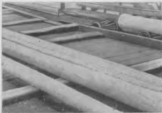
Рис. 1. Поверхность свежесрубленного елового бревна, окоренного на станке ОК-66 с использованием подрезающего ножа
