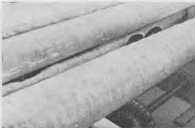
Рис. 2. Поверхность свежеобрубленного елового бревна, окоренного при температуре -25^{\circ} на станке ОК-66, настроенном на «жесткий» режим работы
