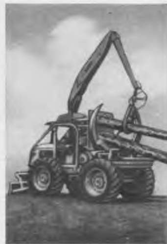
Рис. 3. Бесчokerная машина на базе трактора «Три фармер» (Окончание на 3-й стр. обл.)
