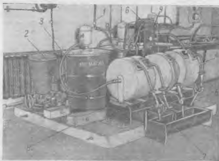
Рис. 1. Пост механизированной смазки мотовозов и тепловозов (депо Верховского леспромхоза):
