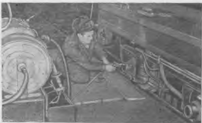
Рис. 2. Смазка мотовоза консистентными смазками
