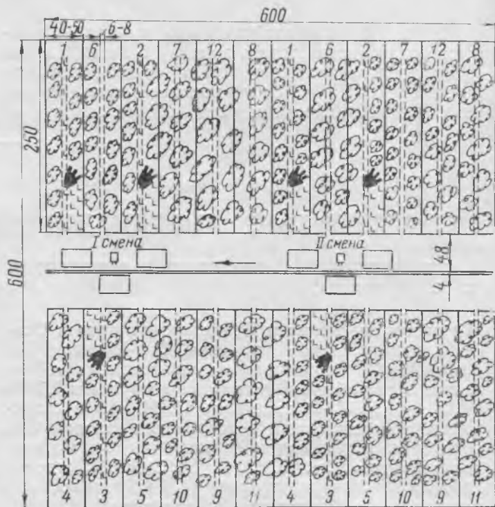
Рис. 2. Технологическая схема разработки лесосеки
