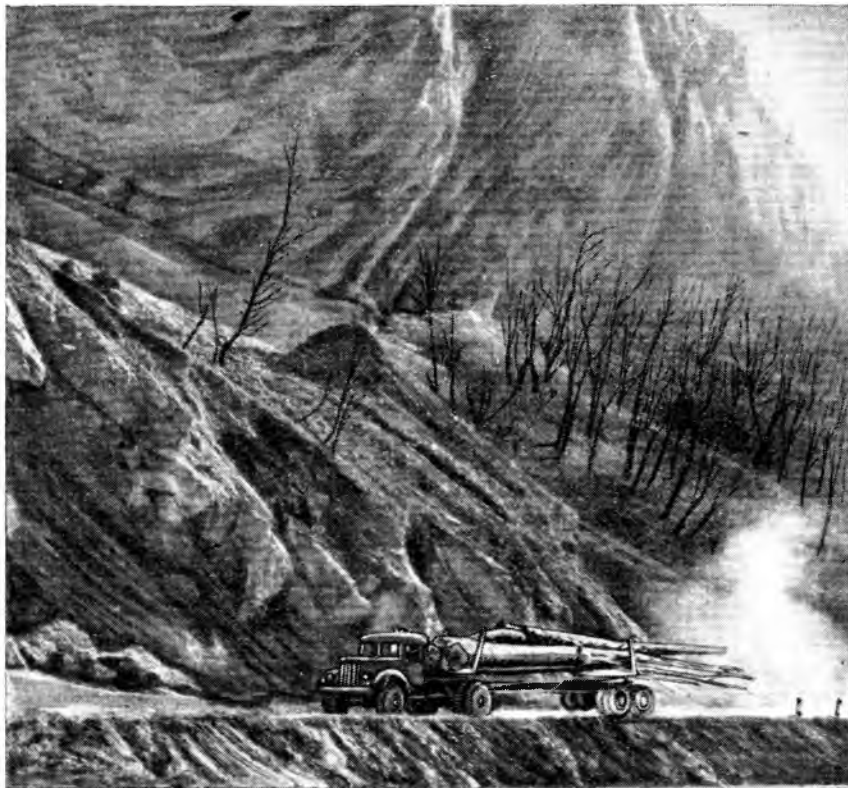
Вывозка хлыстов автомобилем МАЗ-501 с двухосным тормзным прицепом 2-Р-15Т
