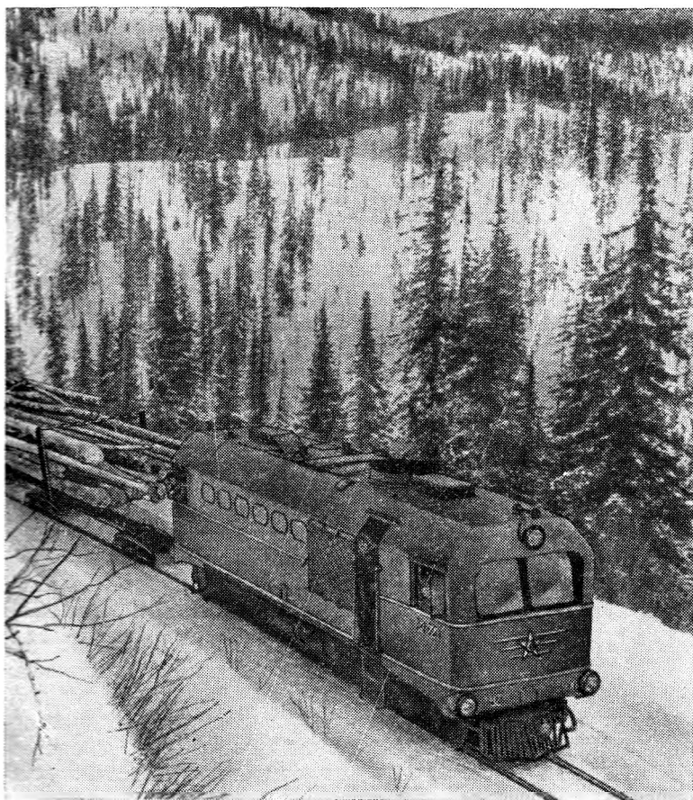
Рис. 2. Вывозка хлыстов по УЖД тепловозом ТУ-2 в горах Алтая
