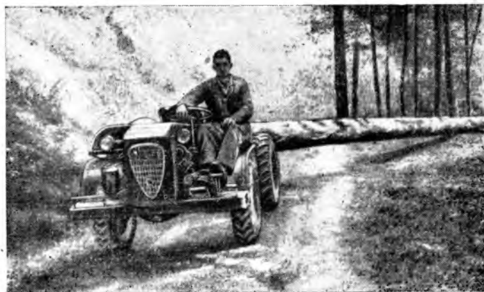
Рис. 6. Вытаскивание хлыста трактором «Пулак» на дорогу
