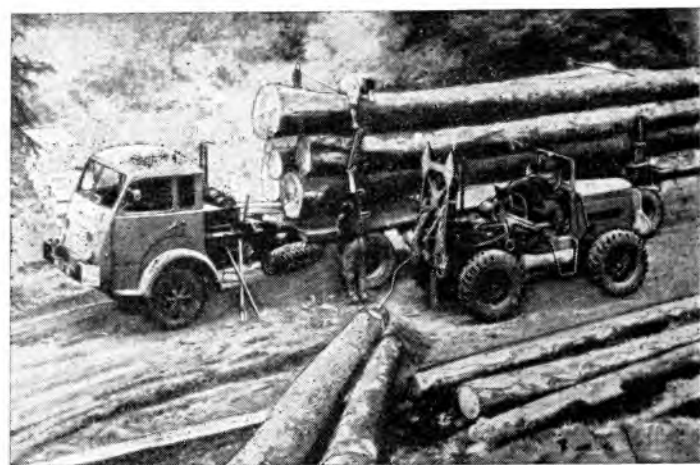
Рис. 4. Трактор подтаскивает лес к автодороге, на которой стоит автопоезд «Савьем»
