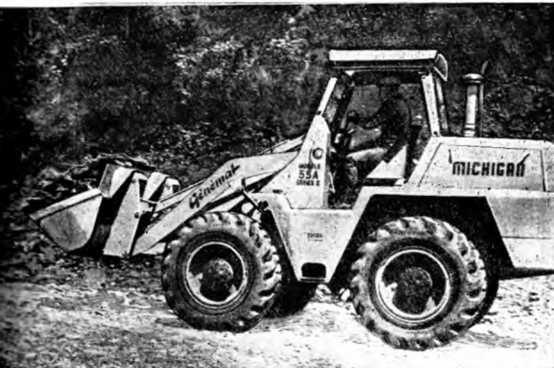
Рис. 13. Самоходный погрузчик «Мичиган» транспортирует гравий
