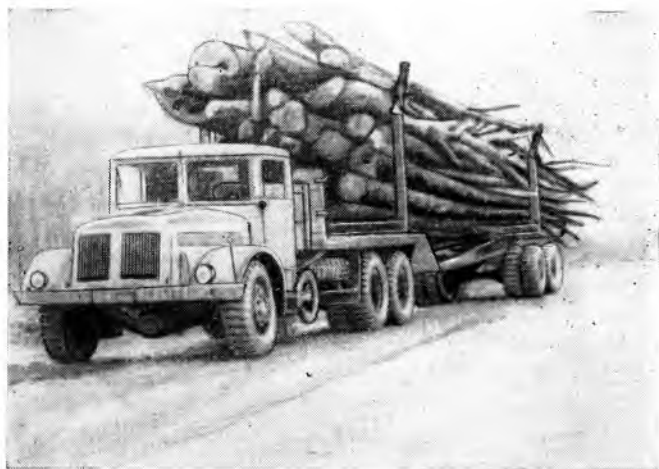
Автомобиль Татра-111R с ролпсуском 2-Р-15Т на вывозке леса в горах
