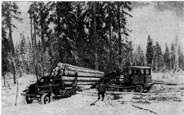
Трактор ТДТ-60 грузит со щита на автомобиль ЗИЛ-157 пачку хлыстов
