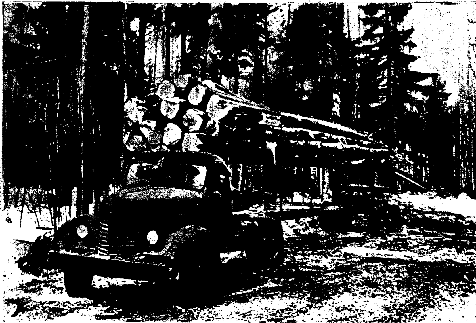
Крупнопакетная погрузка леса. Момент подачи автомашины под погрузку (Комбинат Устюглес, Вологодский совнархоз).
