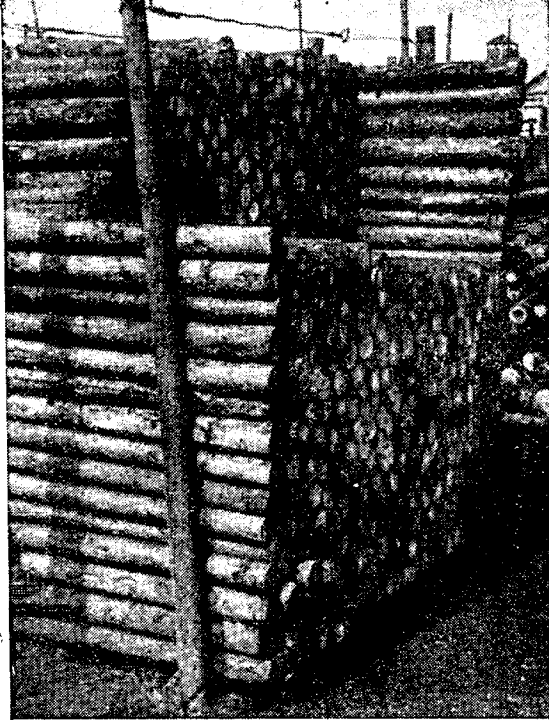
Рис. 3. Укладка короткомерной рудстойки в контейнер в два ряда
