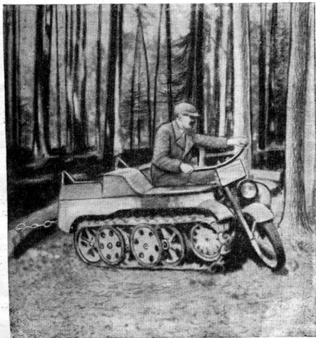
Новая техника на лесозаготовках Чехословакии. Гусеничный мотоцикл на трелевке леса
