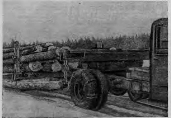
Рис. 3. Подвеска рамных брусьев на цепях
