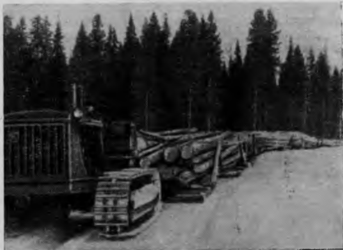
Рис. 4. Тракторный поезд с хлыстами в пути
