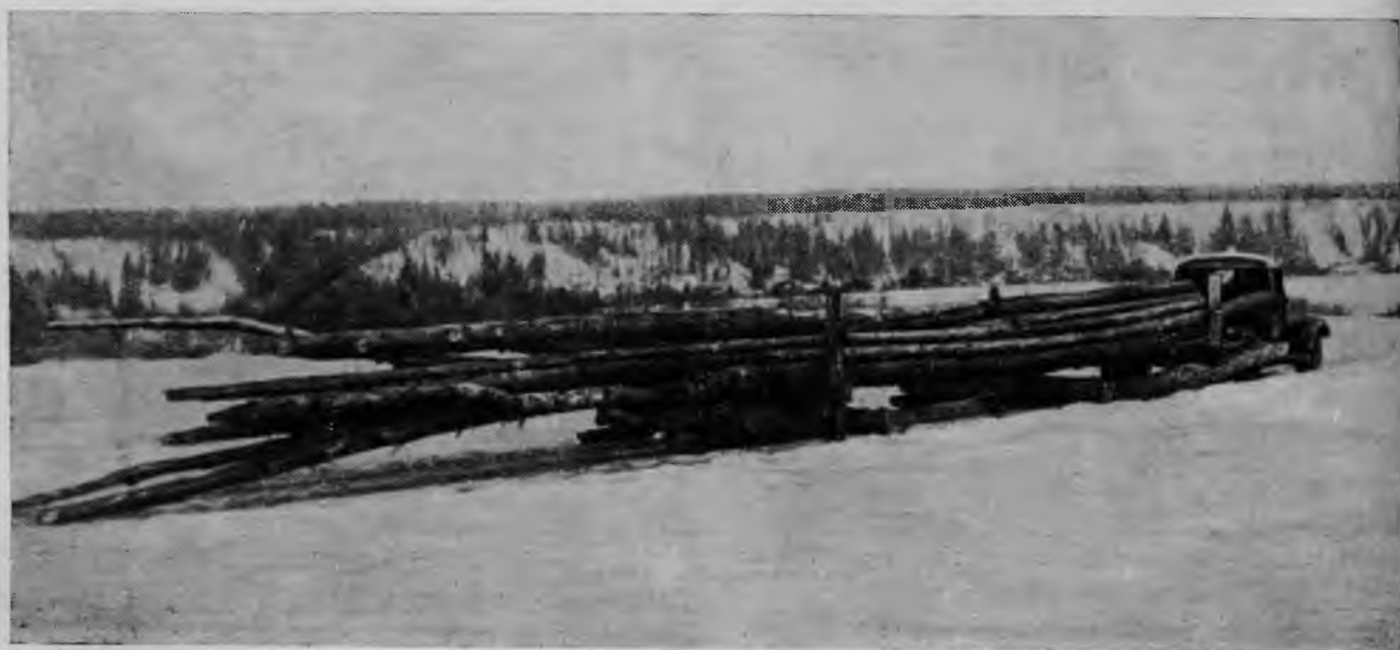
Рис. 6. Автомобиль с санями Устюгlesa в пути с грузом хлыстов
