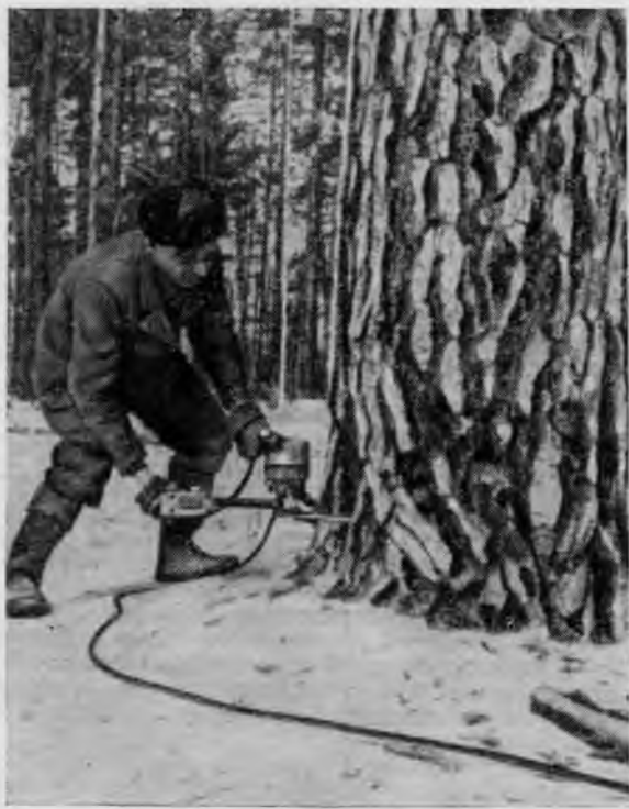
Рис. 3. Валка леса пилой ЦНИИМЭ-К5 в поточно-комплексной бригаде Н. Ф. Павленко (Тулунский леспромхоз)
