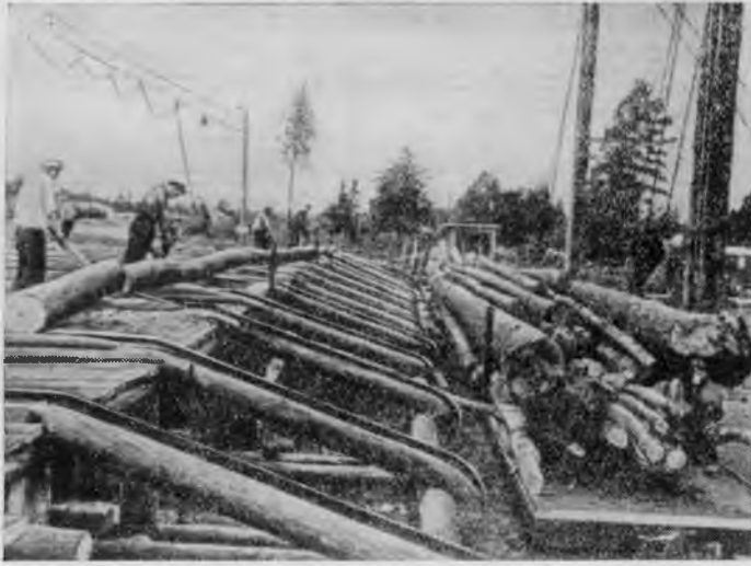
Рис. 8. Сцеп с хлыстами перед разгрузкой у эстакады, где разделяется последний хлыст из предыдущей партии (фото Е. К. Артемьева)
