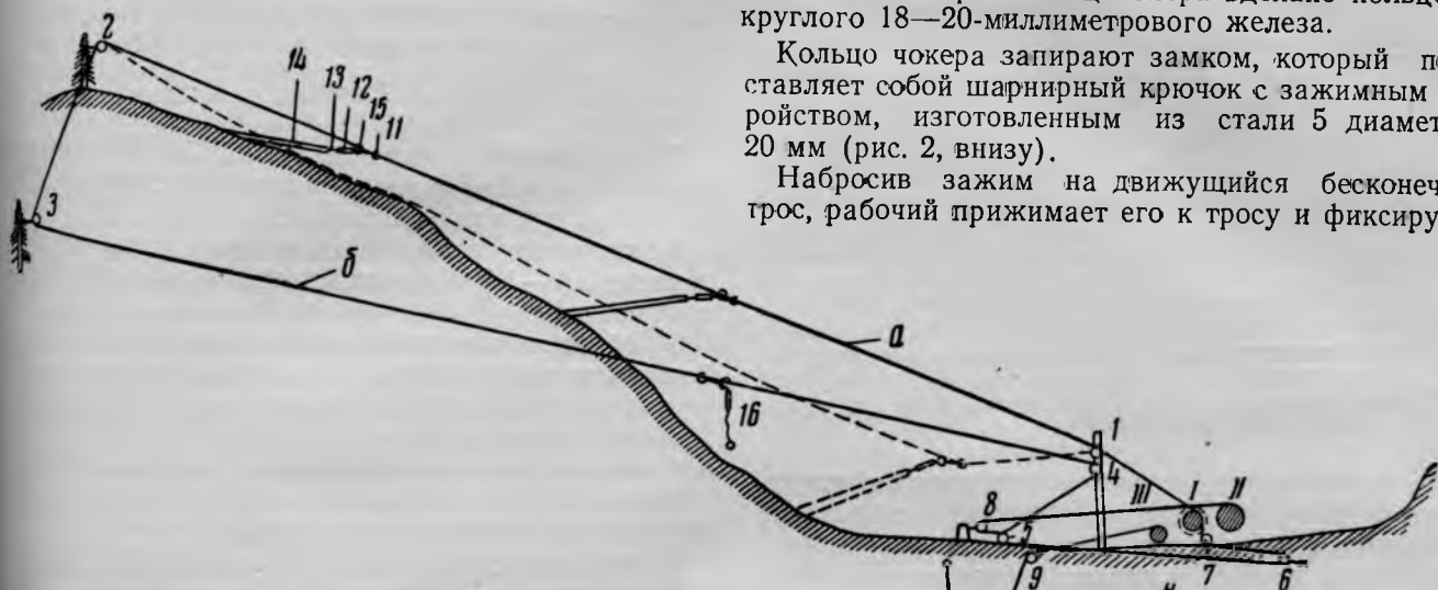
Рис. 1. Схема ризовки леса лебедкой ТЛ-3:
