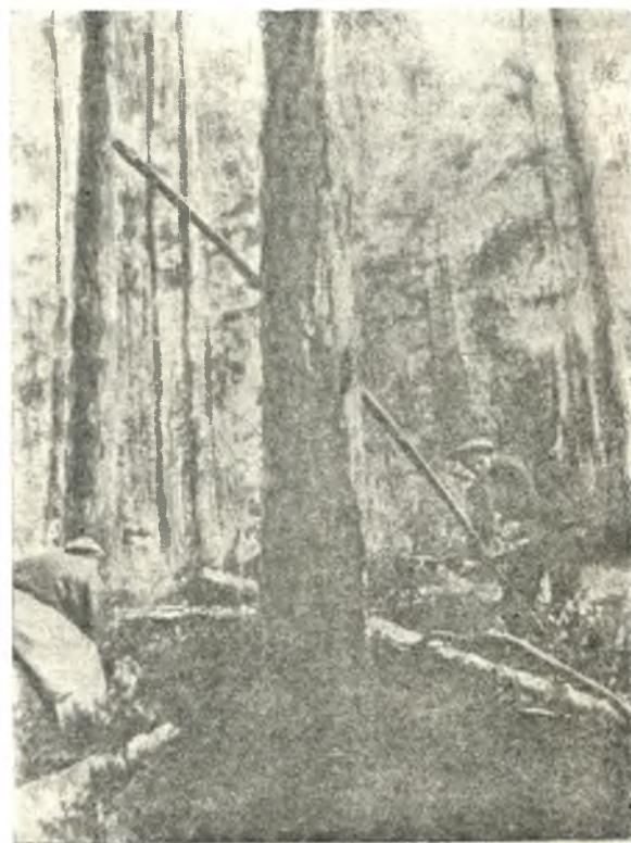
Рис. 2. Валка дерева с помощью винтового домкрата
