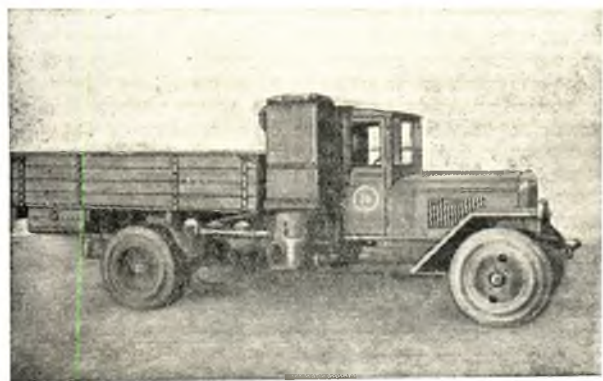
Рис. 1. Автомобиль ЗИС-21А с газогенератором ЦНИИМЭ-20
