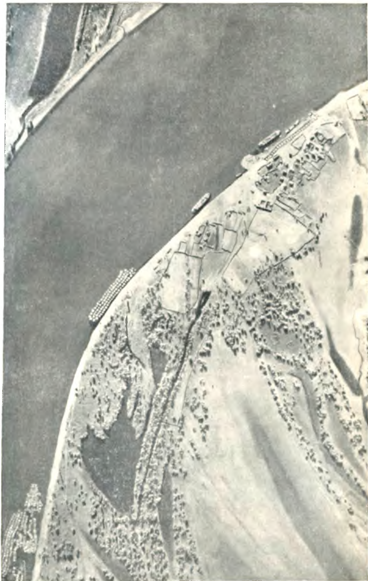
Аэрофотоснимок участка сплавной реки. На снимке хорошо видны подготовка пучков для формирования плотов, готовые пучки и две баржи у берега.
