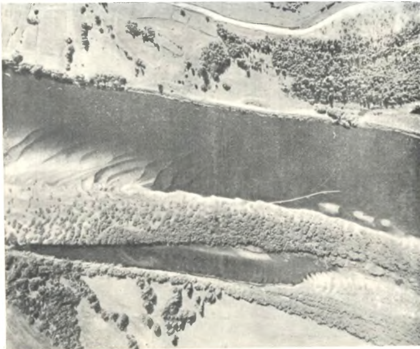
Аэрофотоснимок участка сплавной реки. Слева хорошо различима мель. Справа виден направляющий бон. Вдоль противоположного берега видны отдельные пlyingие бревна
