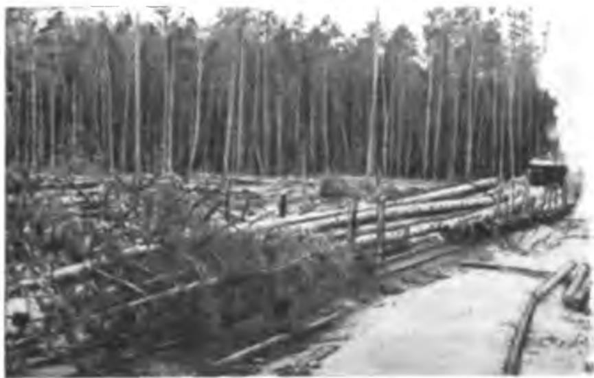
Перевозка хлыстов с кроной по узкоколейной железной дороге
