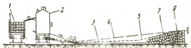
Рис. 2. Схема погрузки леса элеватором ЭЖД-3:
