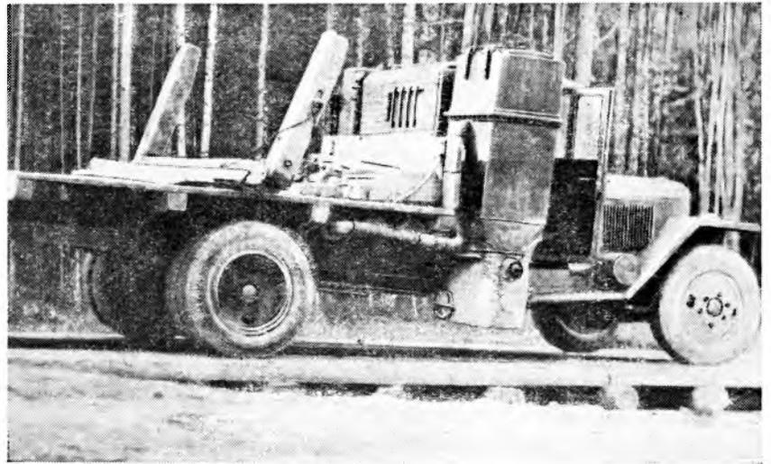
Лесовозный автомобиль с газогенератором системы Кулябина
