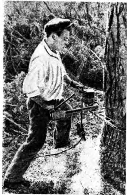
Рис. 3. Моторист г. Коробейников подпиливает дерево пилой ЦНИИМЭ К-5
