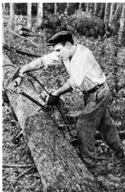
Рис. 4. Моторист т. Коробейников раскряжевывает хлыст электропилой ЦНИИМЭ К-5
