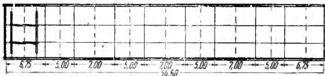
Рис. 3. Схема плота в гибкой обонке
