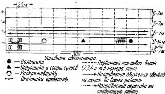
Рис. 2. Схема последовательности разработки лесосеки
