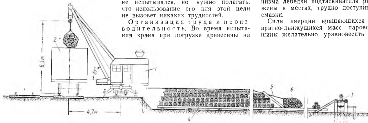
Рис. 2. Схема погрузки и подтаскивания древесины паровым краном на нижнем складе:
