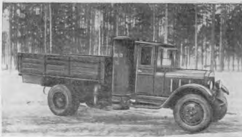
Рис. 1. Общий вид газогенераторного автомобиля ЗИС-31
