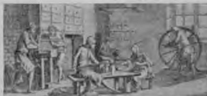
2. Пуговичная мастерская (Франция, 1763 г.). На рисунке представлен процесс внедрения мануфактурного разделения труда в ремесло. Из семи работающих трое используются как двигательная сила
