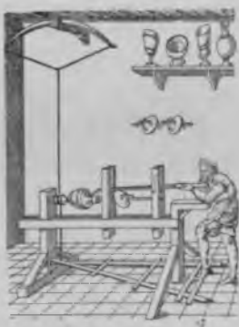
8. Токарный станок Жака Бессона (1578 г., Франция)
