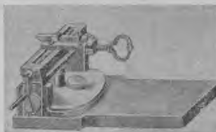
8. Фигурная обточка древесины потребовала всевозможных механических приспособлений. В конце мануфактурного периода и в начале промышленного переворота в конструкциях токарных станков уже появляются прототипы современного суппорта. На рисунке — суппорт для токарного станка французской конструкции (1771 г.)
