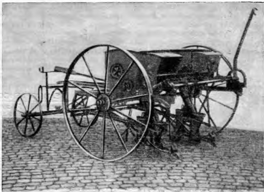
Рис. 1. Конная модернизированная сеялка СЛ-4 с анкерными сменными сошниками.
