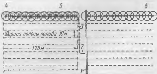
Рис. 8. Схема присоединения и перемещения дождевальных крыльев КДУ-41 при одностороннем поливе.
