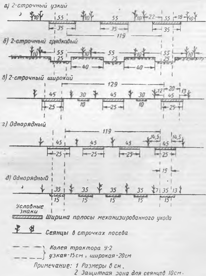
Рис. 2. Новые схемы посевов с обозначением проходимости трактора У-2 и полос механизированного ухода.
