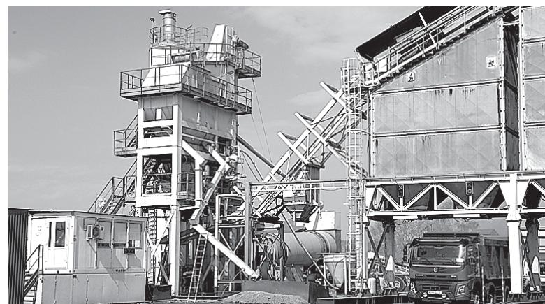
Мощность асфальтобетонной установки составляет 220 тонн в час.
