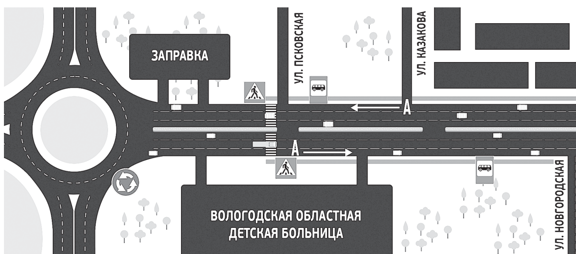
Такой на данный момент представляется схема движения на первом участке с выделенными полосами для общественного транспорта.
