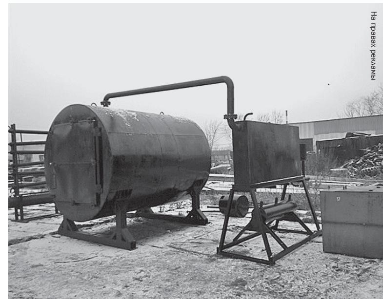
Мобильная пиролизная установка на экспериментальной площадке в Вологде.
