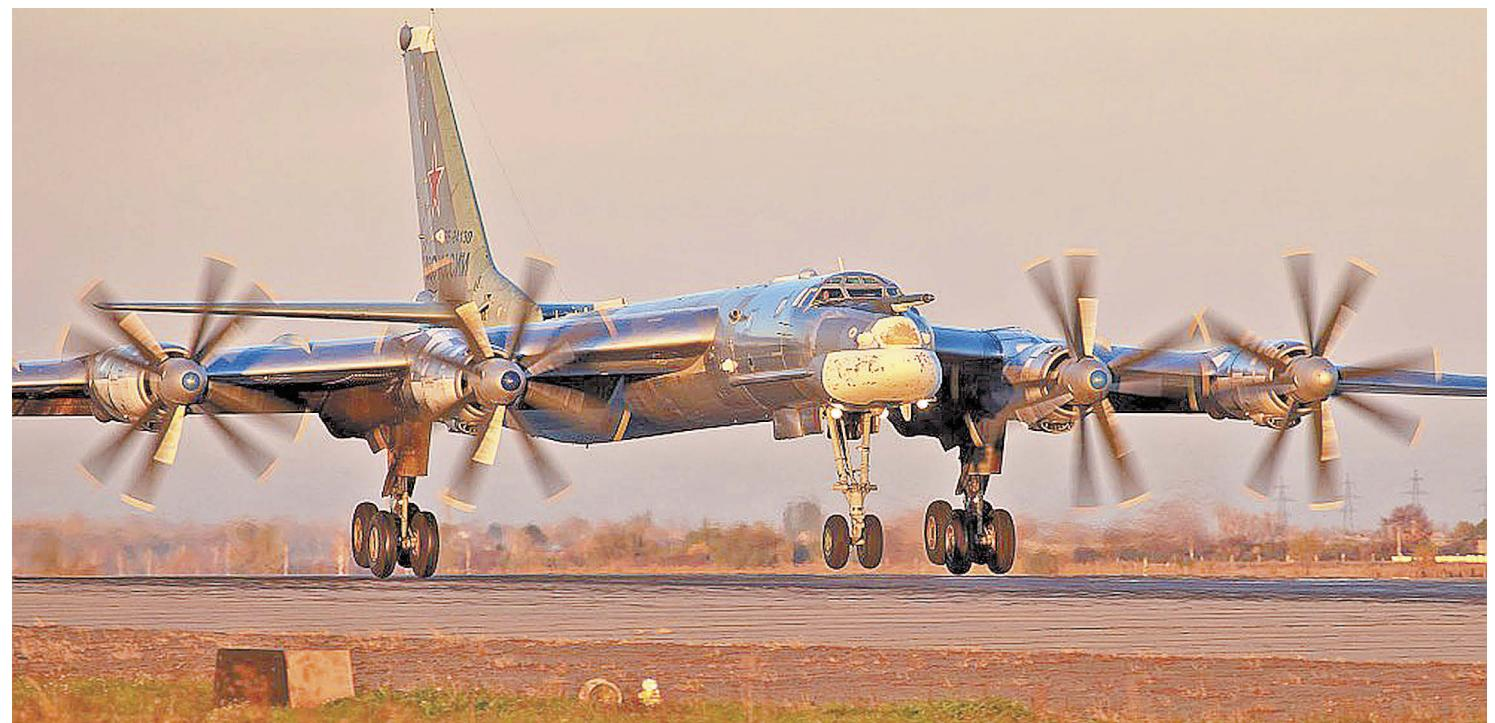
Ту-95МС - единственный в мире серийный бомбардировщик и ракетоносец с турбовинтовыми двигателями, самый скоростной самолет с турбовинтовыми двигателями. Фото с сайта tu-s.mediasole.ru
