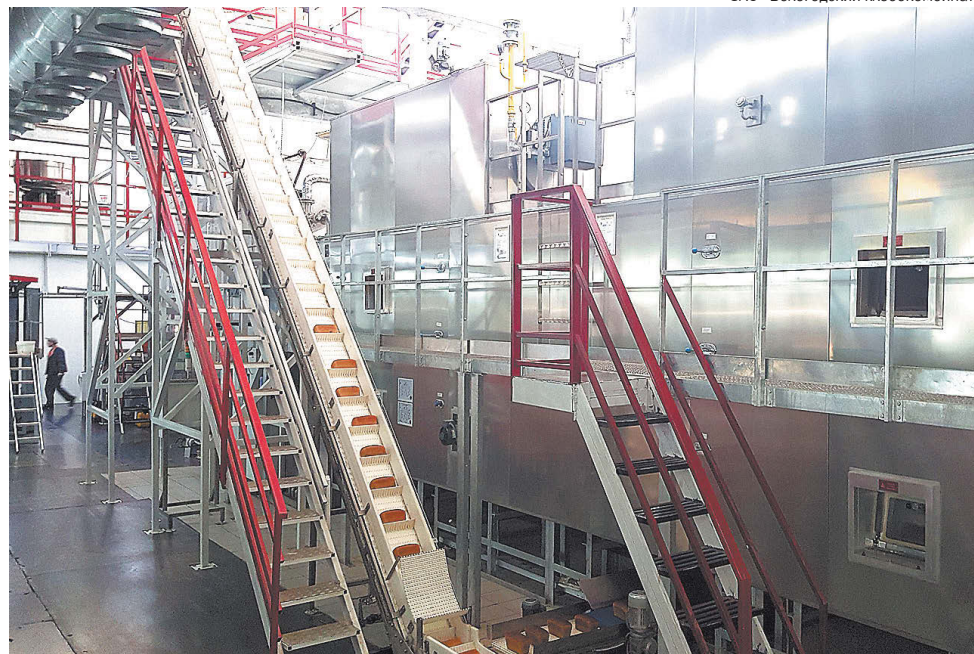
Готовая продукция по сложной системе транспортеров поступает на комбинированные установки охлаждения.
