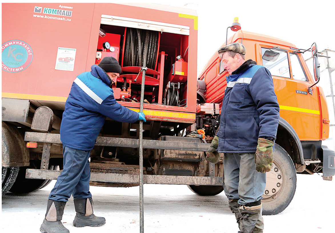
Современная комбинированная машина КО-560 предназначена для промывки инженерных сетей. /Фото Сергея Юрова
