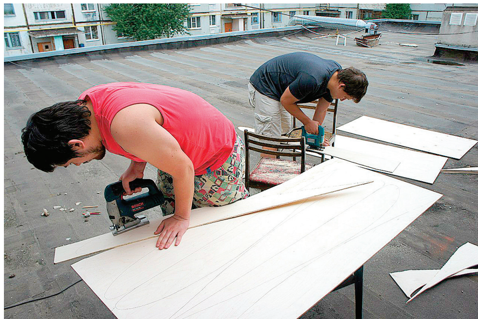
Крылья «Морковколета» делали из фанеры, алюминиевой трубы и пленки.
