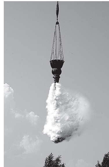
Сброс воды с вертолета Ми-8 (установка СПС-1).
