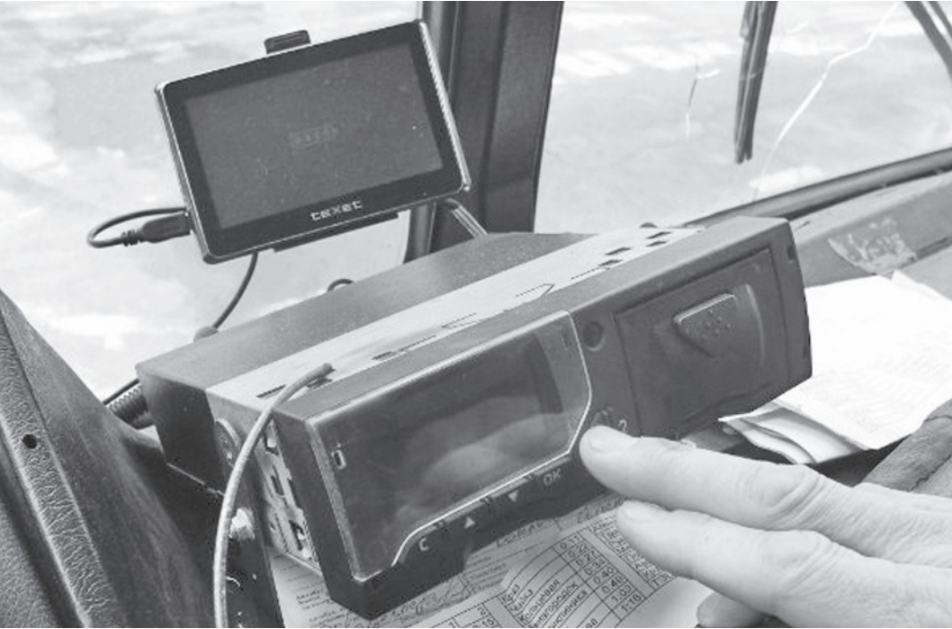
Тахографы - своеобразные «черные ящики», регистрирующие время труда и отдыха водителя, скорость и пробег автомобиля.
