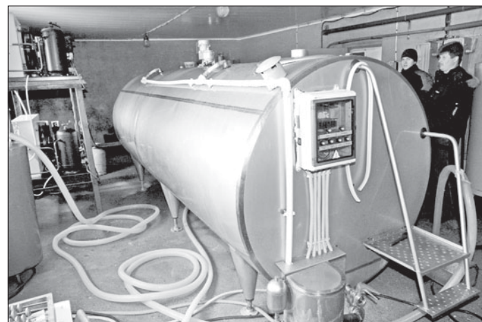
Танк-охладитель, который находится в молочном блоке фермы «Варакисно-2», может вместить в себе 5 тонн молока, которое сначала доводится здесь для лучшего хранения до температуры плюс 4 градуса по Цельсию, а уже затем отправляется в Москву.
