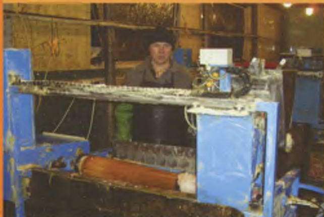
Слесарь-машинист С.П.Рублевский налаживает датский обезжировочный станок Мясокостный фарш, приготовленный для хранения
