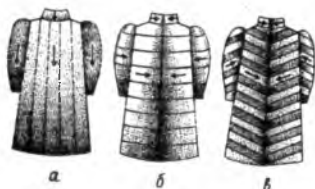
Рис. 4. Расположение шкурок в женском пальто: а — вертикальное; б — горизонтальное; в — в елочку
