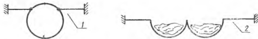
Рис. 3. 1 — вид при транспортировке корма; 2 — вид при кормлении
