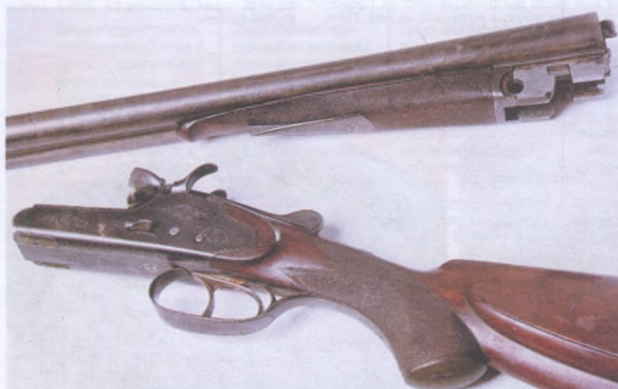
Илл. 4. Двустольное ружьё с коробчатыми замками, изготовленное в 1902 г. по заказу Торгового дома А. А. Биткова
