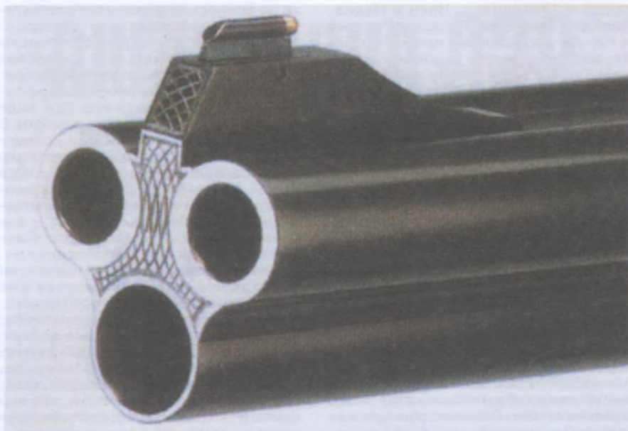
Дульная часть одного из вариантов трехствольного ружья
