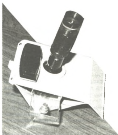
Портативный полевой трихинеллоскоп «Трихинокон»
