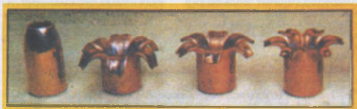
Деформация пули при стрельбе на различные дистанции. Слева направо: пуля до выстрела, деформированные пули при стрельбе на 91, 137 и 159 м
