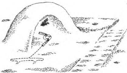
Схема установки капкана в снежном шалаше с использованием зрительной или пахучей приманки.
