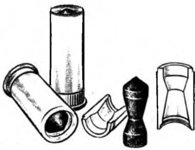
1. Схема рациональной конструкции стрелочной остроконечной пули к нарезному оружию, обладающей высокой пробивной способностью.
