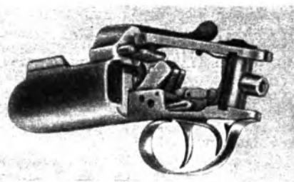
Ствольная коробка с ударно-спусковым механизмом ружья фирмы «Беретта» моделей: S 55 B; S 56 B; S 57 E.
