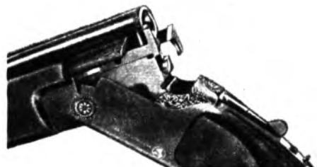
Вид на ружье фирмы «Бреда» со стороны казенной части в раскрытом состоянии.
