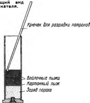
Рис. 2. Пользование крючком-извлекателем при разрядке патронов.
