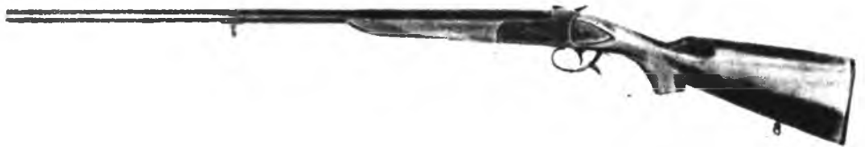
Общий вид одноствольного, однозарядного ружья модели ИЖ-17 с откидным стволом.
