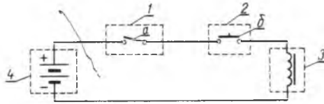
РИС. 1. Принципиальная схема электрического привода к метательным машинкам с применением таймера: узел 1 — исполнительная часть, состоящая из механической или электрической системы, обеспечивающей замыкание контакта «а» пуска мишени один раз в 3 секунды; узел 2 — кнопка (тумблер), подготавливающая питание пускового соленоида метательной машинки. Нажимается по команде стрелка «дай!»; узел 3 — пусковой соленоид метательной машинки; узел 4 — источник питания цепи пускового соленоида (аккумуляторная батарея).
