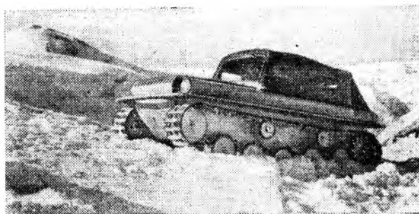
3. На предварительных испытаниях снегоболотоход успешно преодолевает снежную целину в сильно пересеченной местности.
