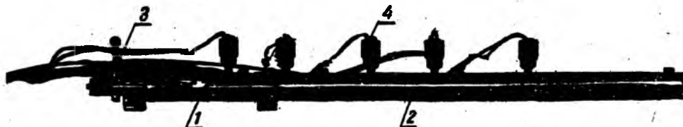
Рис. 1. Общий вид баллистического ружья: 1. Ствольная коробка, 2. Ствол, 3. Затвор, 4. Тензоманометры.
